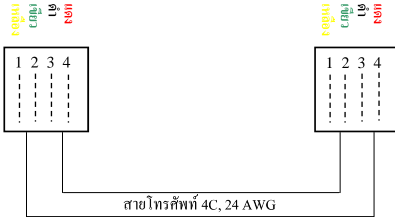
รูปที่ 1 แสดงการเข้าหัว RJ-11 เพื่อใช้ในการต่อระหว่างมิเตอร์กับ n-GATE
